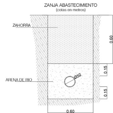
12. Para proceder al relleno de la citada zanja de la red de abastecimiento, es necesario desechar el material existente y aportar zahorra según se observa en la sección tipo adjunta. Teniendo en cuenta los datos de los que disponemos, que la longitud de la zanja a rellenar es de 100,00 metros y las dimensiones y características de la sección tipo de zanja, ¿qué volumen de zahorra una vez compactada será necesaria para completar el relleno?
